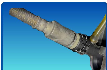
**3** Sin desconectar la línea hidráulica de líquido de frenos ubique el seguro más cercano al purgador.
