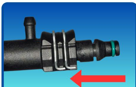
**5** Una vez concluido el purgado empuje o recorra la línea con el conector macho hasta el fondo y coloque el seguro en posición de cerrado evitando que se mueva.
