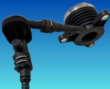
**1** Retire el tapón de la válvula de purgado ubicado en la entrada de la pipeta del collarín.
