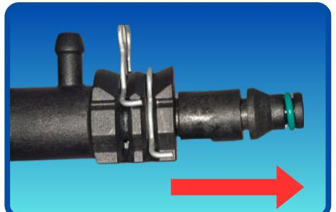
**4** Jale y desplace el conector macho conectado al collarín; esto va permitir que se abra la línea del purgador y poder realizar el purgado.
